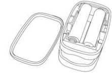
Figura 3. Instalación de baterías
